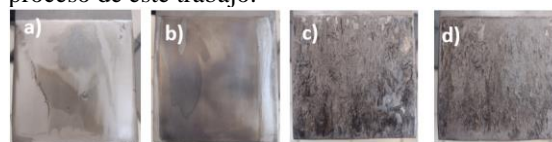
Figure 3 – Cátodos, a) y b) celda de 2 compartimentos paralelo orientación izquierda y derecha, c) y d) 3 compartimentos superficies paralelas a ánodo izquierdo y derecho respectivamente
