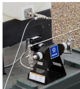
Imagen 1. Sistema de Bombeo inhibidor
